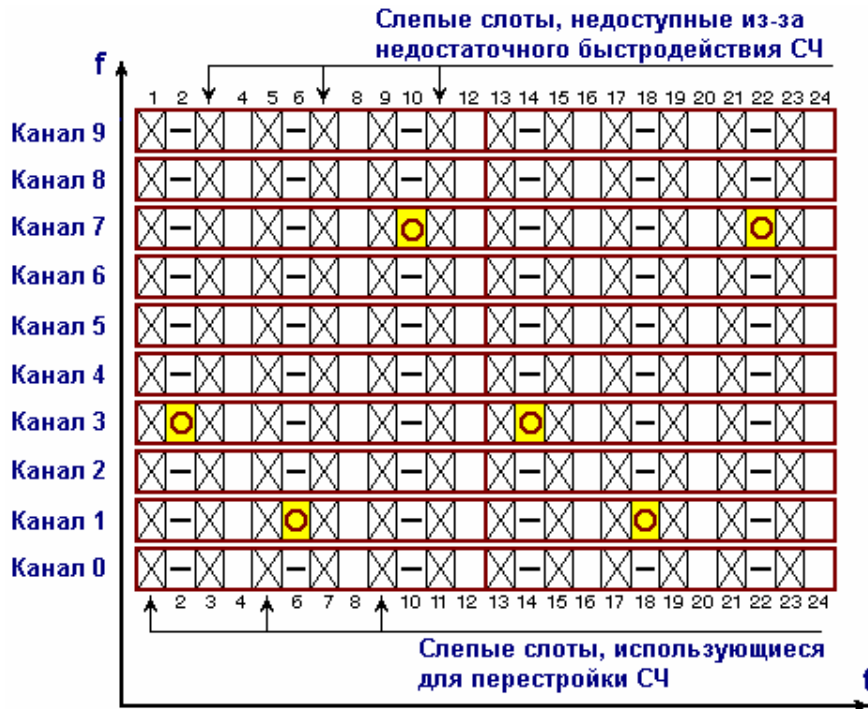
Рис. 32. Образование слепых слотов в DECT PC блоке с одним синтезатором частот
