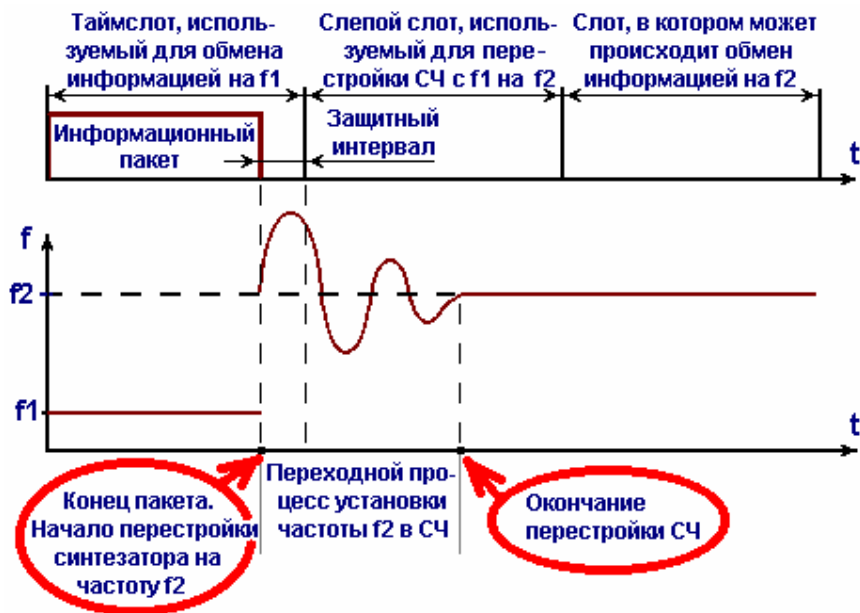
Рис. 31. Механизм образования слепых слотов
